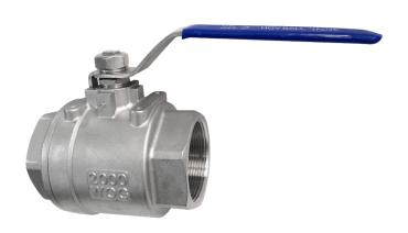
Cuerpo Acero Inoxidable ASTM A351 CF3M 2000 WOG 1/4"~1" | 1500 WOG 1 1/4" - 2" Paso Estándar | Esfera Sólida Vástago Antifugas | Asiento RPTFE Sistema de Bloqueo | Extremos Roscados NPT ASME B1.20.1
