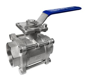
Cuerpo Acero Inoxidable ASTM A351 CF3M 2000 WOG 1/4"~1" | 1500 WOG 1 1/4" - 2" Paso Estándar | Esfera Solida | Montaje Directo ISO 5211 Vástago a Prueba de Escape | Asiento RPTFE Sistema de Bloqueo | Roscado End NPT ASME B1.20.1
